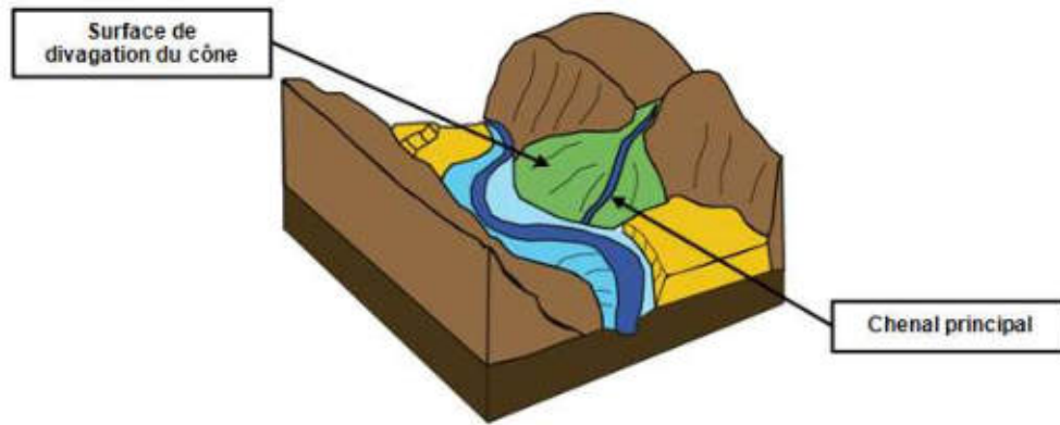
Figure 38 : Structures morphologiques d'un cours d'eau torrentiel [Source : SIEE]
