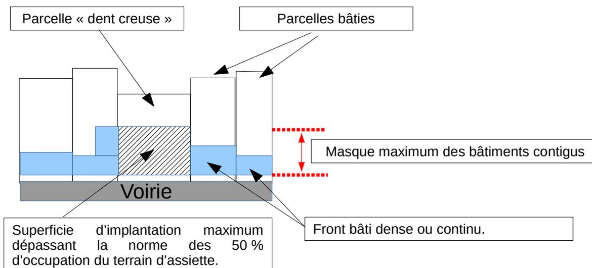
Sera également considéré comme dent creuse à l'étage le cas d'une construction en rez-de-chaussée insérée dans un front bâti continu majoritairement constitué de bâtiments R+1 a minima comme illustré ci-dessous :
