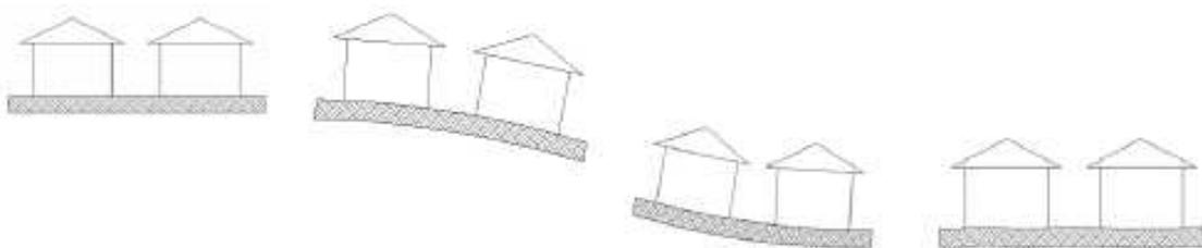
En fin d'affaissement, le bâti se trouve sur l'une de ces quatre configurations.
