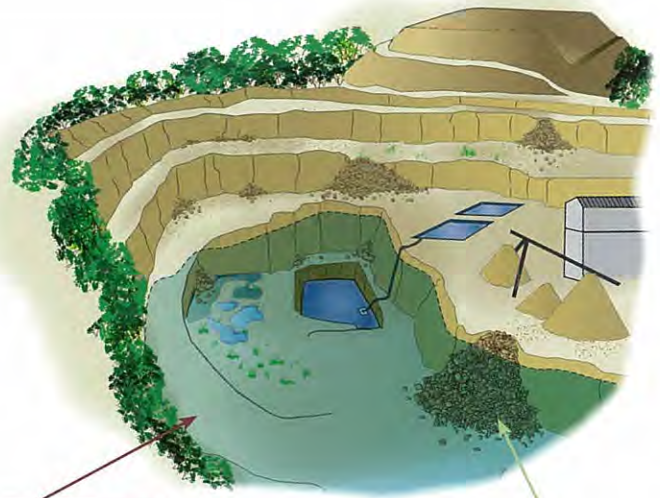
Partie de la fosse qui sera envoyée après arrêt du pompage
