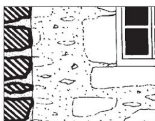
Joints à pierre vue
