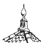
Épi de faîtage
