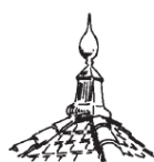
Épi de faîtage
