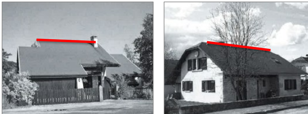
Lignes de faîtages (en rouge) dans le sens de la plus grande longueur (Dreffia, CAUE de l'Ain)
