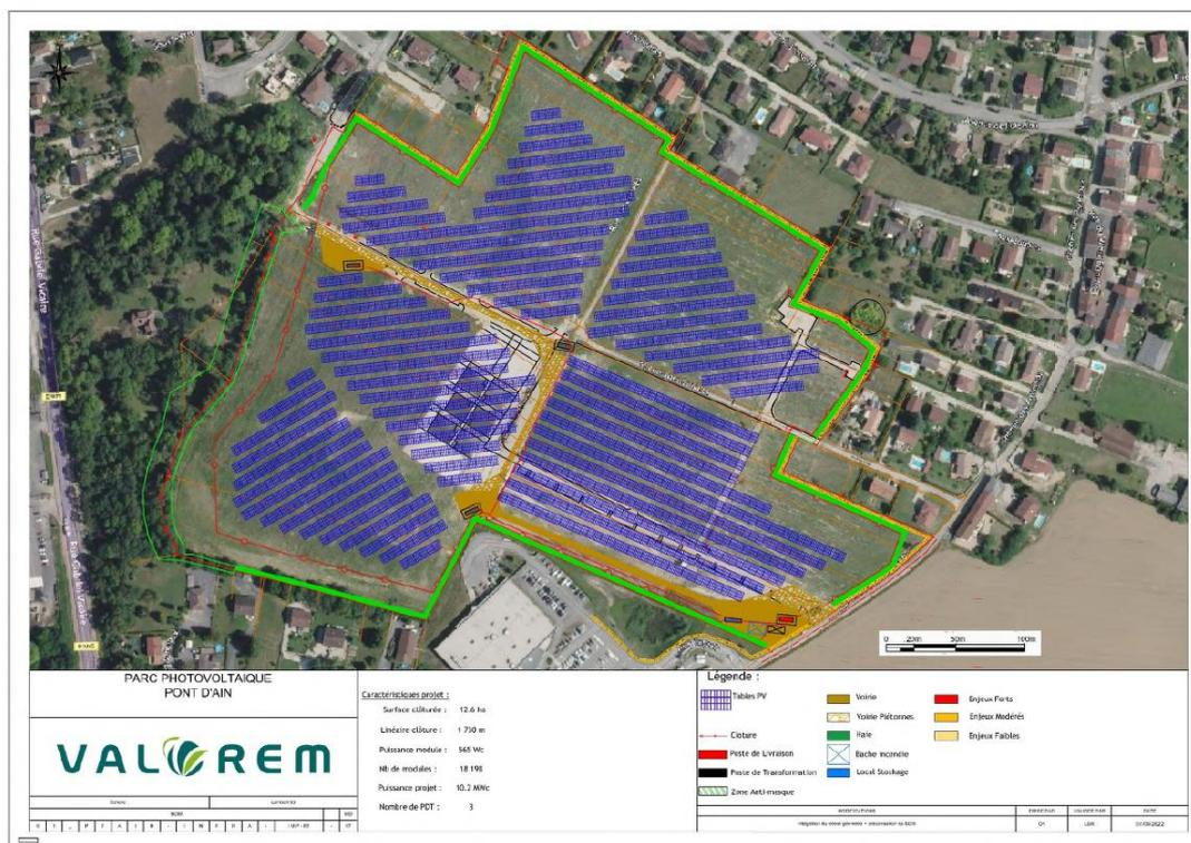
**Figure 1 : plan d'implantation des panneaux PV (source : PV Pont d'Ain énergie)**
