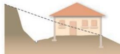
Plate-forme en déblais
