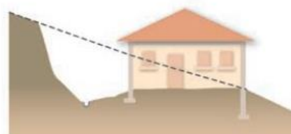
Plate-forme en déblais
