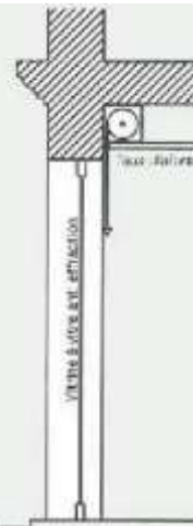
Caisson du volet roulant placé à l'intérieur du local
