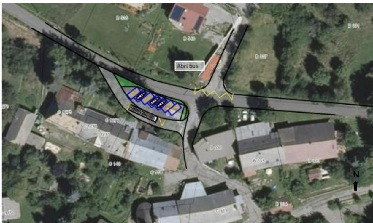
Comme le met en évidence le schéma de principe du projet d'aire de stationnement, l'accès aux places stationnement pourra se faire par un accès interne en sens unique qui permettra d'accueillir également un arrêt bus sécurisé dans le sens de la montée.
