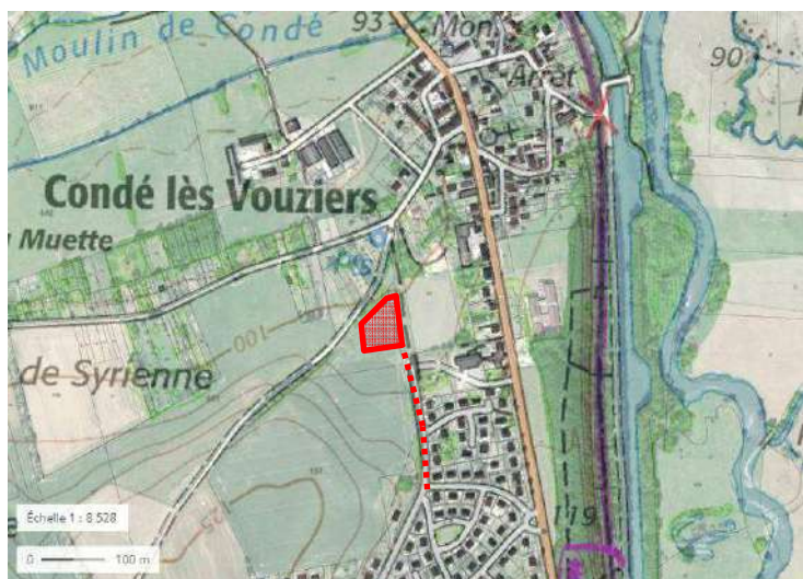
Localisation des travaux (bassin d'orage et canalisation Ø 800)
