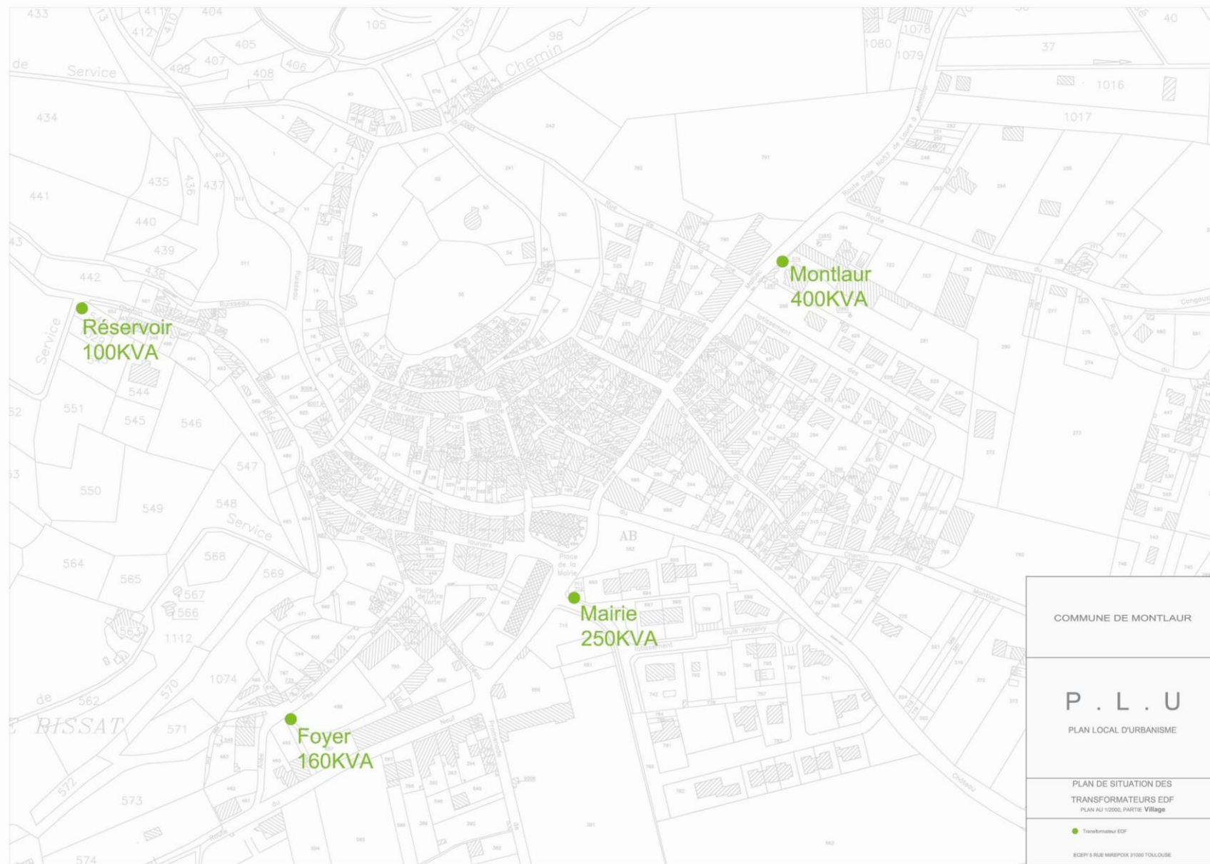
Carte 34 : situation des transformateurs EDF dans le village
