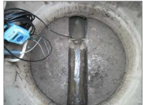
L'erreur relative sur la mesure de débit est généralement due au dépôt engendré en amont du déversoir par le faible débit dans la canalisation. La sonde est alors plongée dans le dépôt et on assiste à un phénomène de dérive des mesures.
