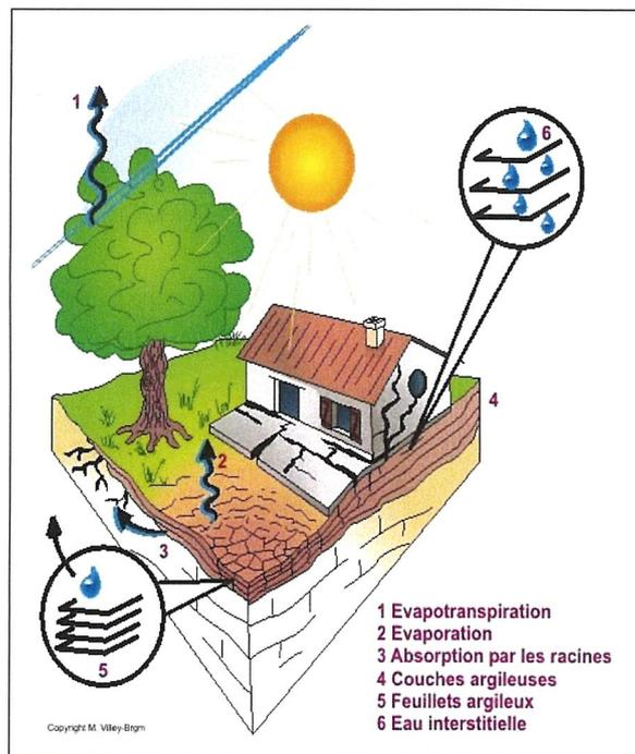
fig. 1 : illustration du mécanisme de dessiccation
