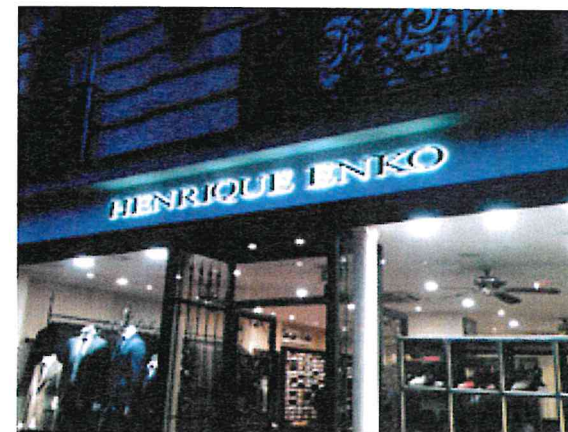
Lettres boîtiers en aluminium Eclairage LED par la tranche
