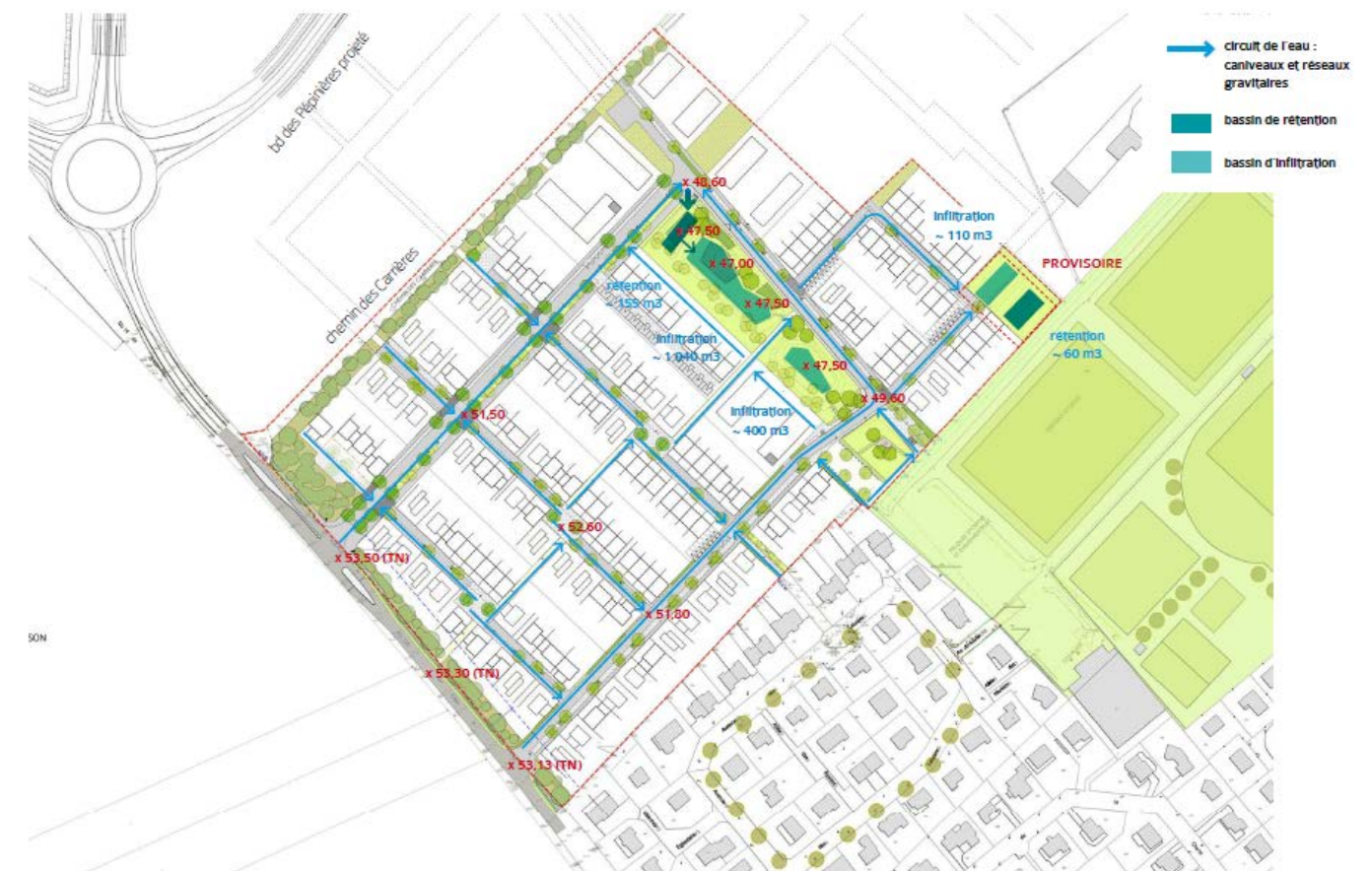
Figure 26 : Schéma de principe sur la gestion de l'eau définie au dossier de réalisation
