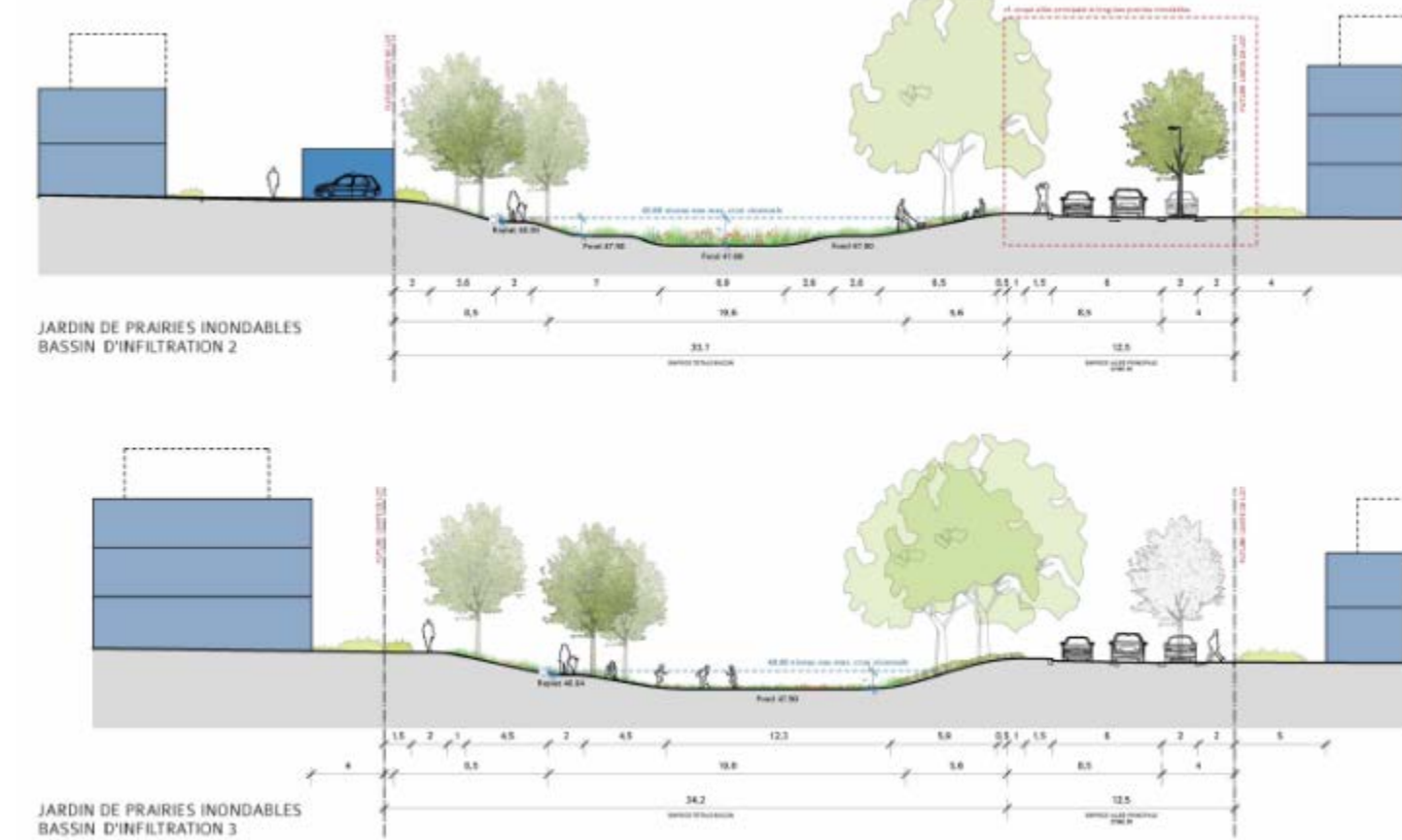
Figure 7 : Coupes sur bassins d'infiltration
