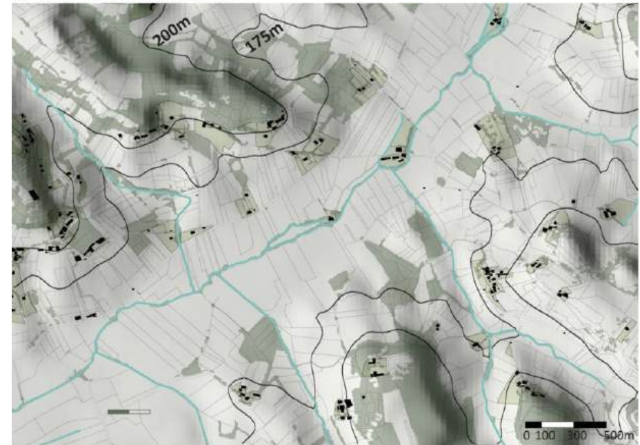
EXEMPLE D'IMPLANTATION LE LONG DES COURBES DE NIVEAUX DANS LA VALLÉE DU LENDOU
