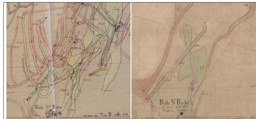
Figure 4 : Extrait de plans miniers du site de Chalmeton - Quartier du puits sainte Barbe (à gauche plan d'ensemble des travaux souterrains sous niveaux – à droite plan d'exploitation du niveau 112)
