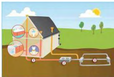
Figure 2-27 : Installation d'assainissement non-collectif
