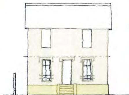
Surélévation avec les mêmes pentes de toiture, ravalement unifiant les deux parties de la construction
