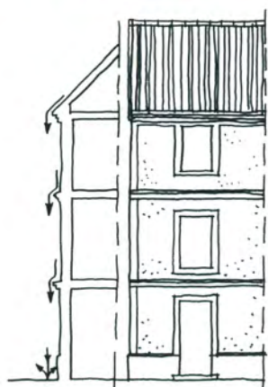
Les éléments en saillie protègent la façade contre l'eau de pluie et les salissures.
