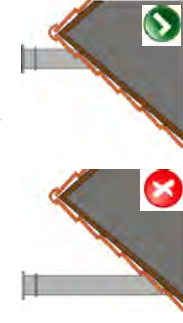
TRAVAUX INADAPTÉS : Positionner le conduit en bas de pente BONNE PRATIQUE : Positionner le conduit au plus près du faîte pour limiter la hauteur de conduit
