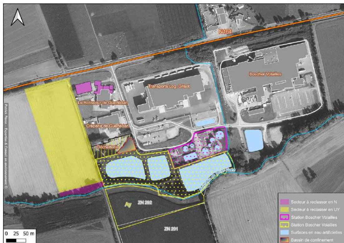
Station d'épuration de Boscher Volailles
