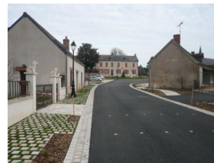
La place de l'ancien bourg est relativement « minéral », mais elle préserve un aspect enherbé pour rester proche de la typologie des accotements dans les bourgs ruraux.
