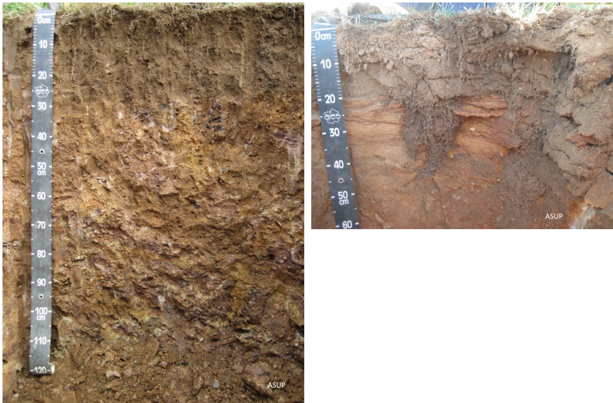
Photo 5 : exemple de deux sols du Ségala : sol moyennement épais sur schistes (à gauche), sol superficiel sur grès (à droite)
