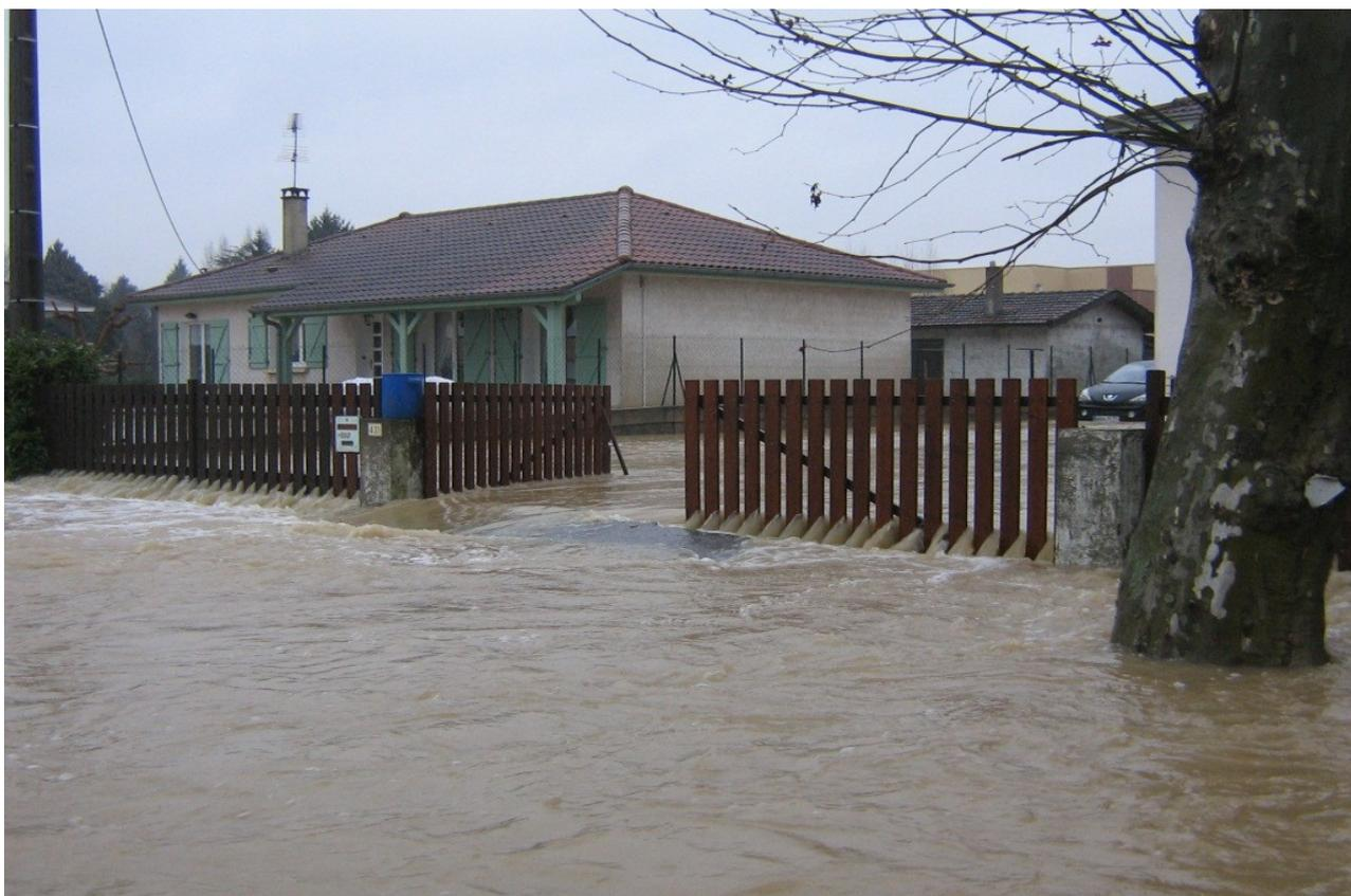
*Crue de février 2009 – Route de Chaveyriat – Obstacle aux écoulements induit par un portail*
