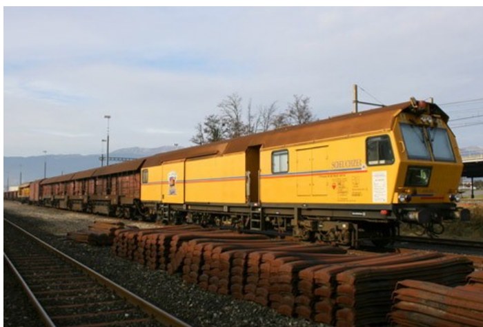
Train meuleur de rails (Scheuchzer S.A.)
