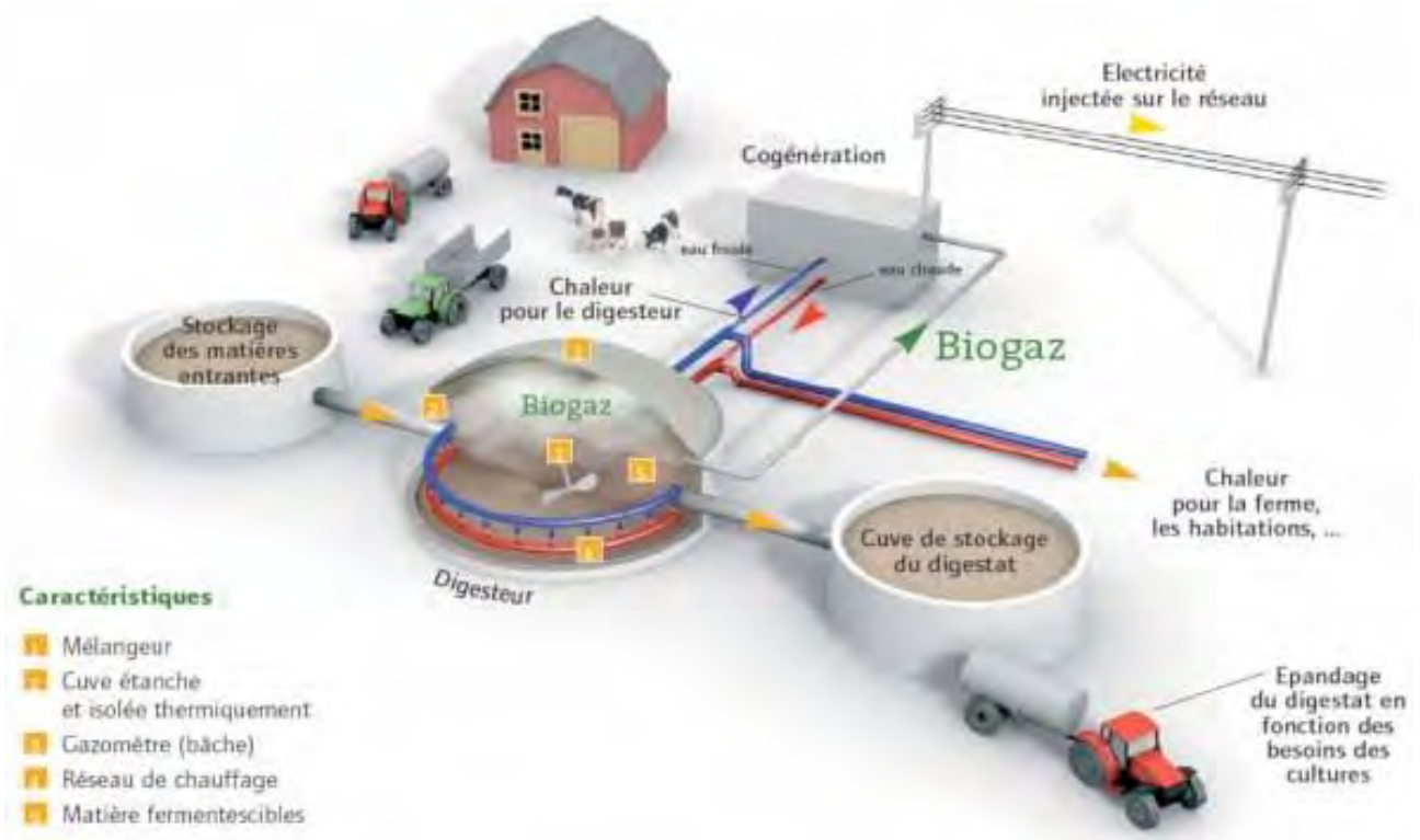
Processus de la méthanisation (source : Agrivalor)
