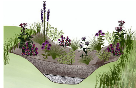
Coupe d'un jardin de pluie avec drain
