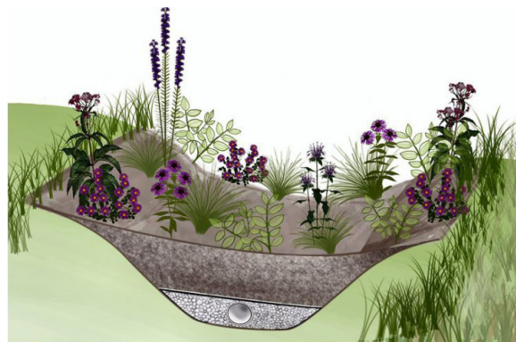
Coupe d'un jardin de pluie avec drain
