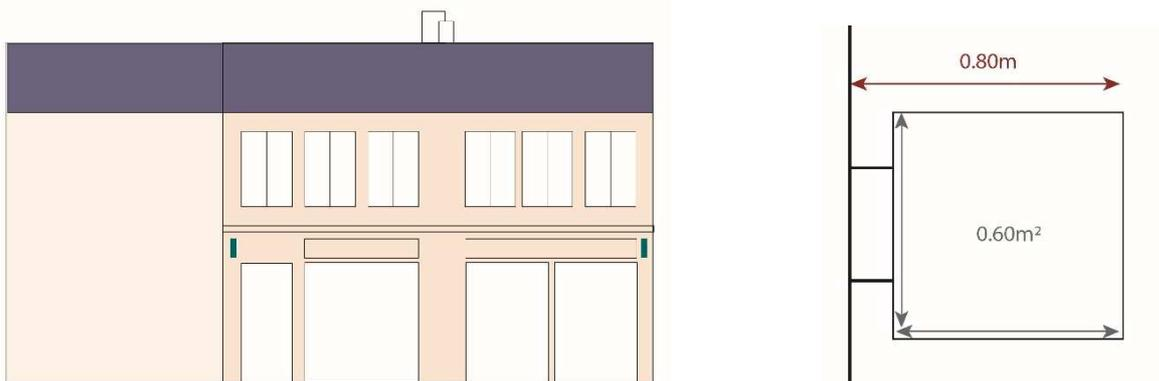
La surface maximale est de 0.60m<sup>2</sup> par face d'enseigne perpendiculaire (hors fixation). Sous réserve de respecter la réglementation nationale et le règlement général de voirie, la saillie des enseignes perpendiculaires est limitée à 0.80m maximum support inclus.
