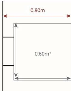
La surface maximale est de 0.60m<sup>2</sup> par face d'enseigne perpendiculaire (hors fixation). Sous réserve de respecter la réglementation nationale et le règlement général de voirie, la saillie des enseignes perpendiculaires est limitée à 0.80m maximum support inclus.
