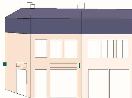
L'enseigne perpendiculaire doit être implantée en limite latérale de la façade commerciale. Elle est placée entre le haut des baies du rez-de-chaussée et l'appui des fenêtres du premier étage.
