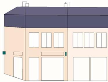
L'enseigne perpendiculaire doit être implantée en limite latérale de la façade commerciale. Elle est placée entre le haut des baies du rez-de-chaussée et l'appui des fenêtres du premier étage dans la limite d'une hauteur de 5m par rapport au niveau du sol ou du trottoir.
