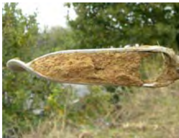
Photo du sondage n°2 montrant un sol sain sur 50 cm.
