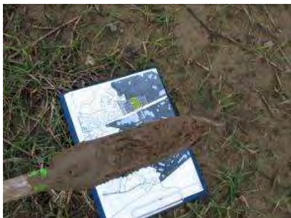
Sondage tarière 1 (=69) Traces d'hydromorphie dès les horizons superficiels du sol
