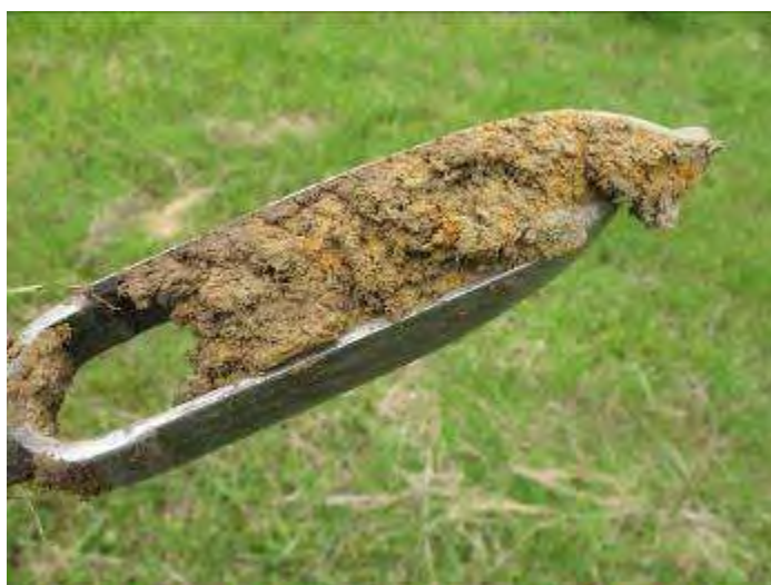
Sondage 24 : Oxydation importante
