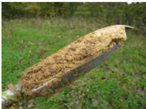
Photo du sondage n°20, montrant une oxydation importante puis une transition avec un horizon réductique
