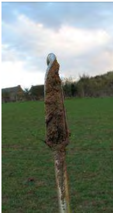
Sondage tarière 6 (=74) Absence d'eau libre - hydromorphie moindre
