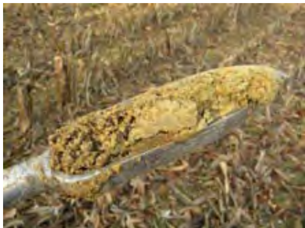
Photo du sondage n° 7 : Hydromorphie importante en surface, puis disparaissant en profondeur
