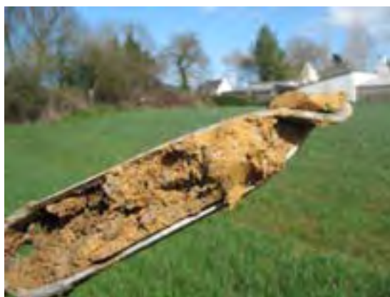
Sondage n°20 montrant une hydromorphie importante dans les 50 1 er cm du sol.
