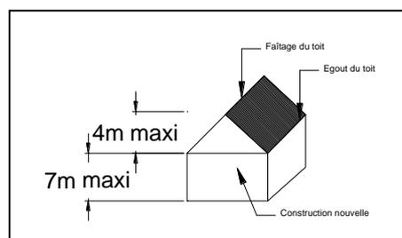
**Égout du toit** : partie inférieure d'un versant de toit situé en surplomb d'un mur.
