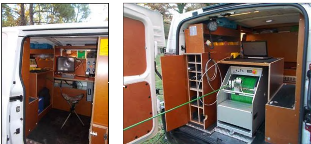
Figure 6 : Atelier d'inspection télévisée
