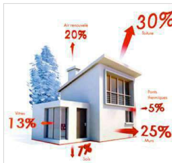
Source de déperdition énergétique au niveau d'une habitation individuelle.
