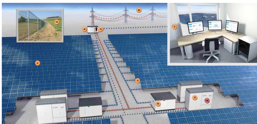
Figure 5 : Schéma de principe des composants d'un parc photovoltaïque ( source étude d'impact )
