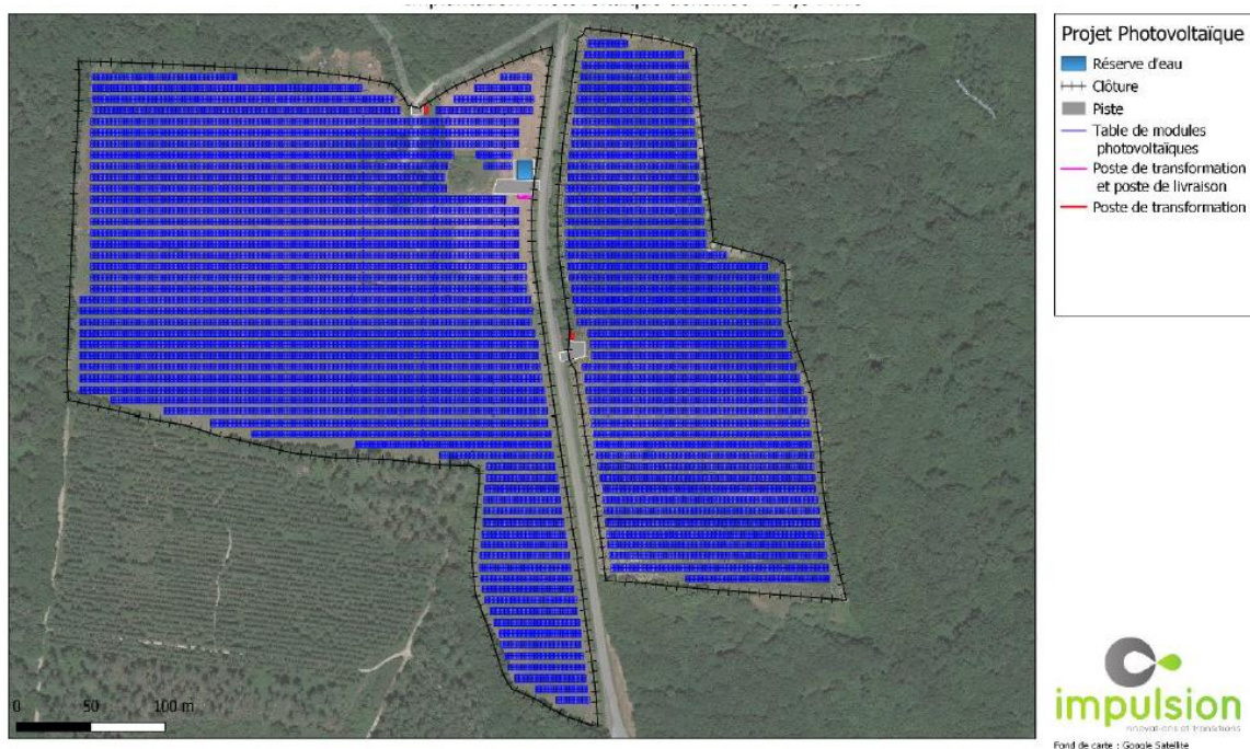
Figure 38 : Variante 1 : l'optimum de production électrique - Source : étude d'impact
