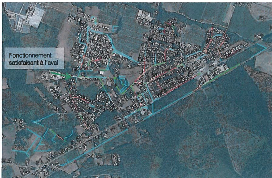
Figure 25 : Résultats de la modélisation après renforcement des collecteurs pluviaux et création d'un bassin de rétention
