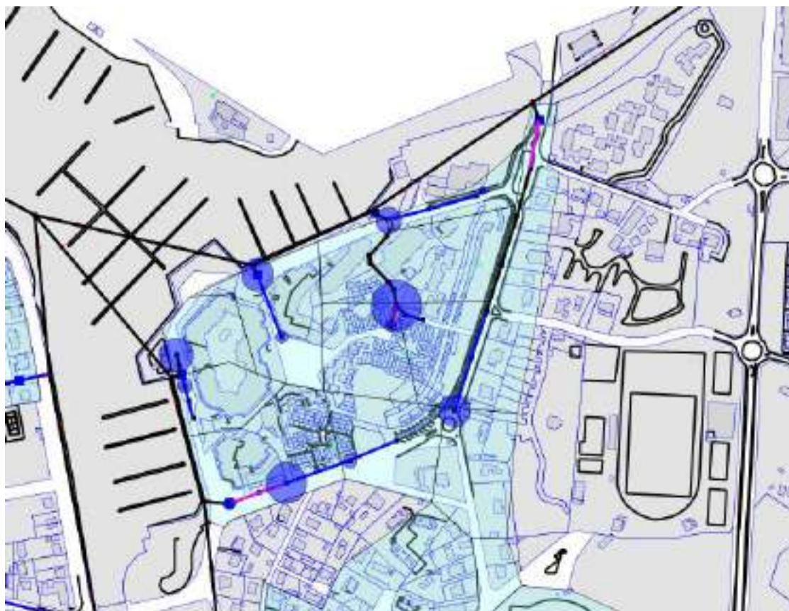
Figure 30 : Quais Pêcherie/Bonamour/rue Martin / Avenue Leclerc Débordements modélisés – Etat initial Marée Haute P10-2h
