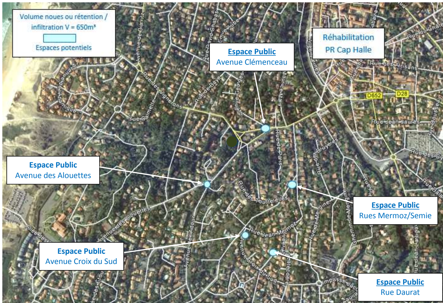
Espaces Potentiels sur le Bassin Versant Cap Halle pour l'implantation de rétentions/infiltrations
