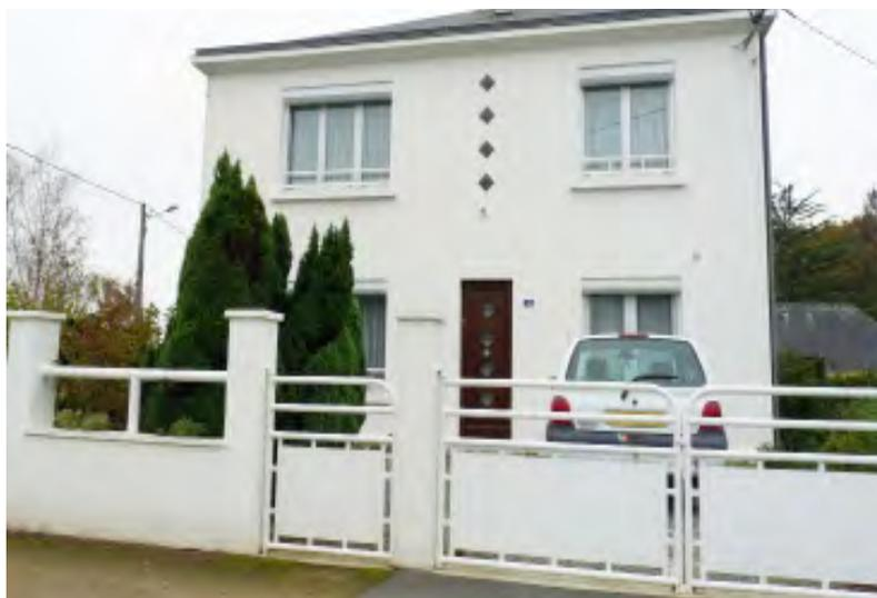
Composition de la clôture en harmonie avec la façade. On retrouve le même dessin des lisses de la clôture et des garde corps des fenêtres. Muret avec larmier. Portail et portillon de même facture, avec la partie haute alignée sur la lisse horizontale.
