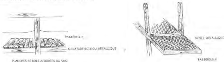
PLATELAGES CONSEILLES POUR PASSERELLE ET PLATE-FORME
