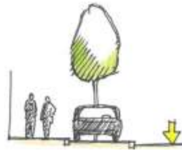
Dissocier l'espace piéton et l'espace circulé (alignement d'arbres associé à du stationnement)
