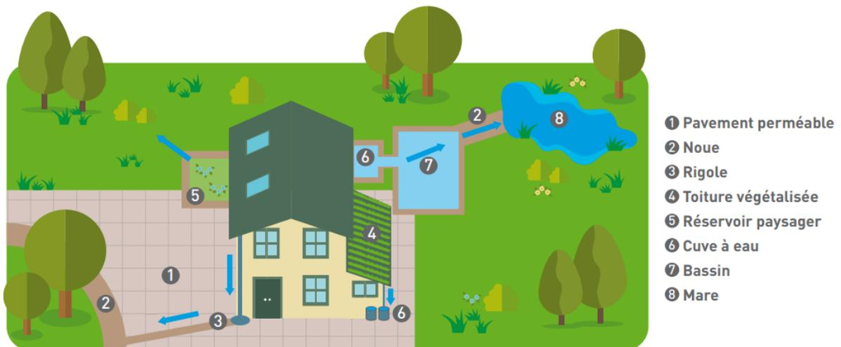
Figure 15 - Exemple de différentes techniques alternatives possibles pour gérer les eaux pluviales d'une maison –
