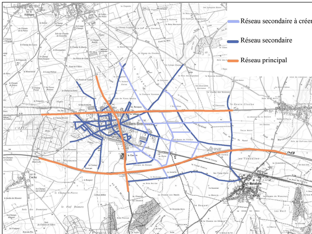
Structure d'orientation viaire
