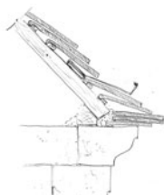
C - Gouttière havraise (ou nantaise) posée sur l'égout de toit.
