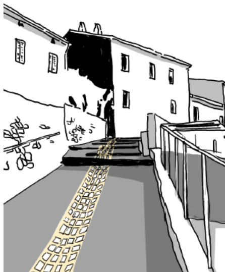
Béton gris et caniveau central en pierre
