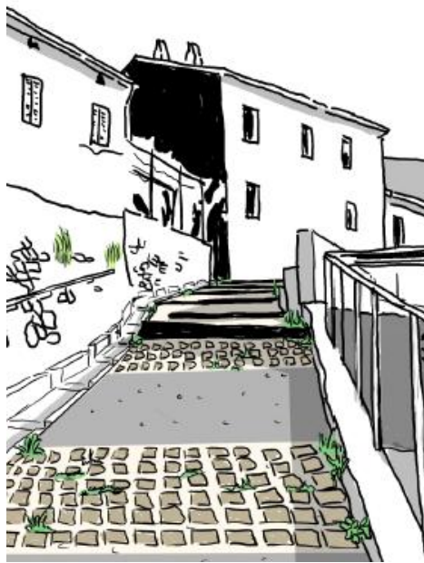
Alternance bande bitumée et pavage Caniveau latéral
