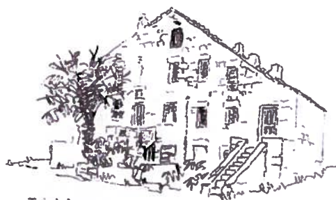
Toit à deux versants faitage perpendiculaire à la façade principale - Figari
