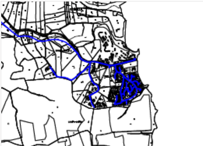
Réseau d'adduction en eau potable (relié au réseau)
