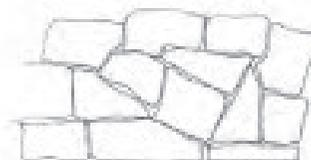
Joints trop saillants, écaillés avec dépassement de mortier, encore appelés "beurrés"
