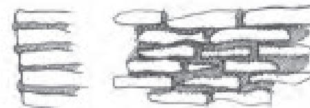
Pilages reportés, matériaux mis en oeuvre de façon reportée, scellée ou agrafée : solutions à éviter, le rendu final produit dans la plupart des cas un effet artificiel, sans l'effet de masse recherché.
