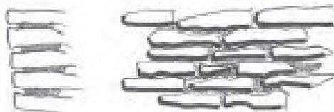
Joints avec fixation tirée au fer sur le corps d'enduit encore frais
