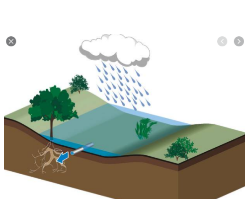
Exemple de noue artificielle en milieu naturel ou sur les espaces libres de plantations
