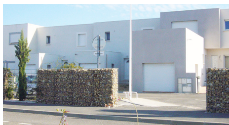
Ici des gabions, non pas utilisés en parement de façades mais pour réaliser des murs de clôture
